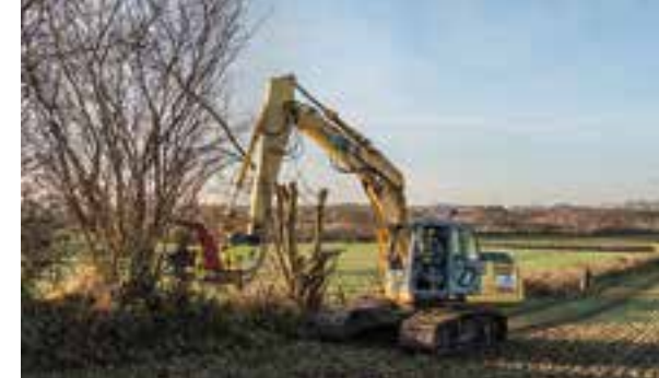
Die hydraulisch betriebene Knickschere wurde speziell für die Knickpflege entwickelt und erleichtert die Arbeit erheblich.
